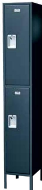
经典型升级系列储物柜用于更坚固的应用。该系列有单、双或三层配置, 14 gauge 厚度的门和 16 gauge 厚度的全尺寸加强槽, 固定在 11 gauge 厚度的框架上, 同时带有免维护的单点锁扣装置。
